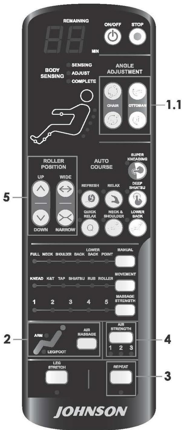
**1** Регулирование положения спинки и подножки.
